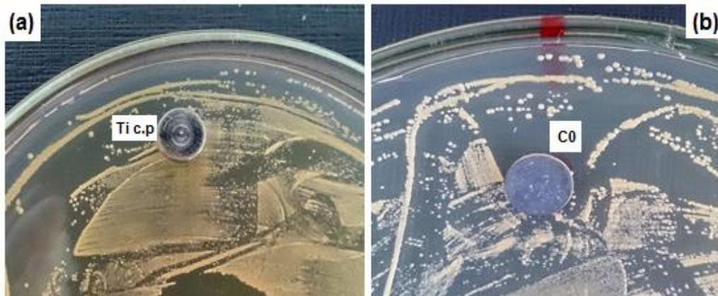
Figura 38 - Resultado do ensaio de halo de inibição; (a) Ti c.p; (b) C0 (Ti c.p+HA).
