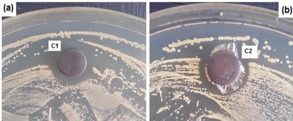
Figura 39 - Resultado do ensaio de halo de inibição; (a) C1 (Ti c.p+HA+AgNO<sub>3</sub>); (b) C2 (Ti c.p+HA+AgNO<sub>3</sub>+Q).
