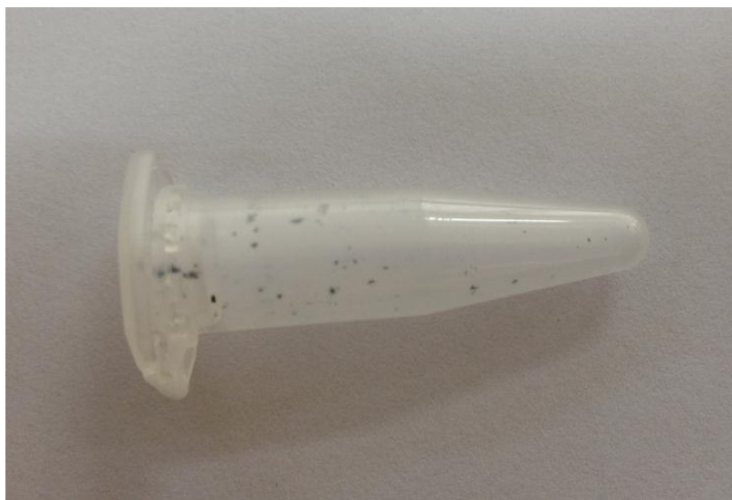
Figura 34 - Resíduo carbonizado (pontos pretos) proveniente da análise de TGA da amostra D, guardados no porta amostra laboratorial de polietileno. Fonte: do autor
