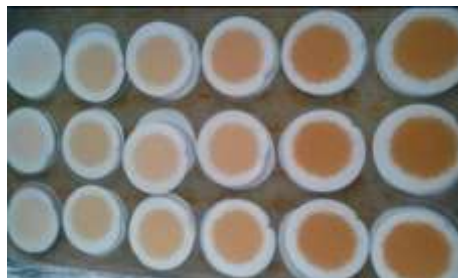
Figura 9- Filtros após filtração de diferentes concentrações. Fonte: Da autora.
