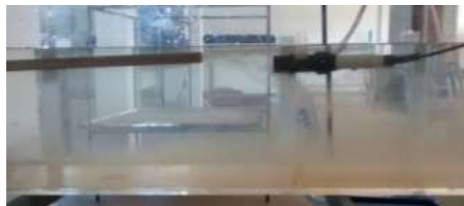
Figura 5- Entrada de sedimento no canal em frente ao sensor de turbidez. Fonte: Da autora.
