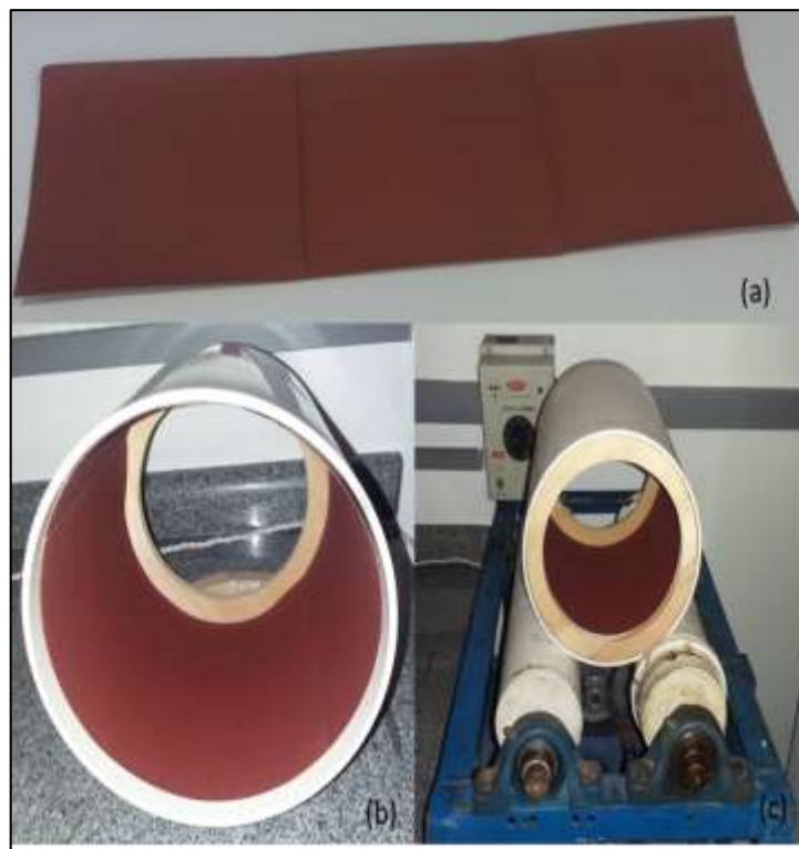
Figura 4.5 – Equipamento abrasivo (a) lixa, (b) tambor abrasivo revestido (c) equipamento completo.
