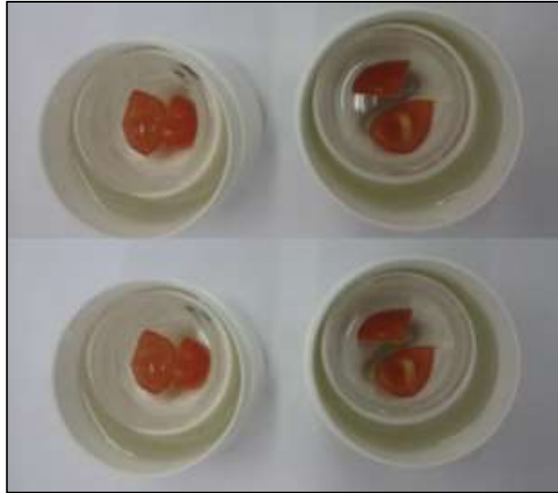
Figura 4.4 – Amostras em pesa-filtro colocados em recipiente sobre solução salina.
