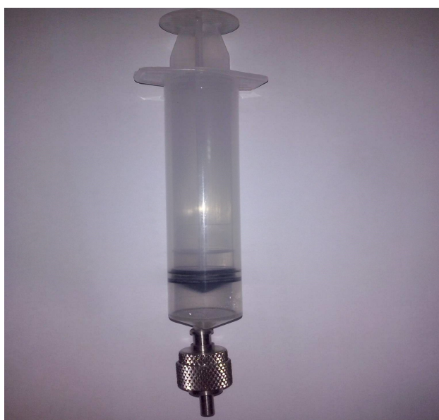
Figura 11- Módulo de filtração. Fonte: Do Autor.
