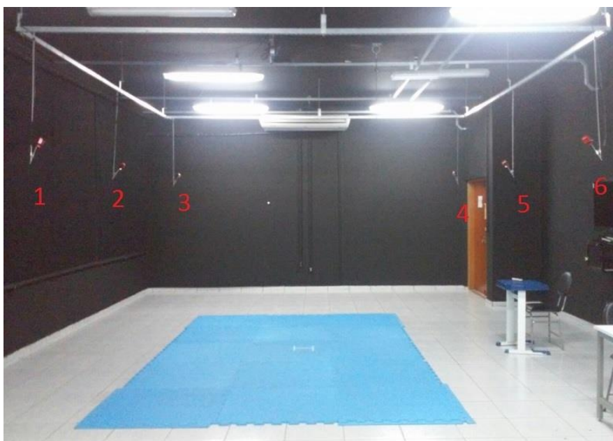
Figura 9 – Esquema de posicionamento das câmeras no laboratório. Fonte: Do autor
