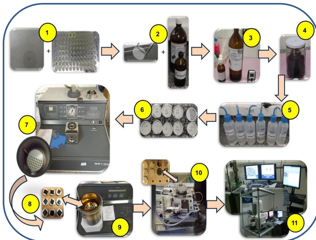
Figura 18 - Preparo de amostras e análise em MEV.
